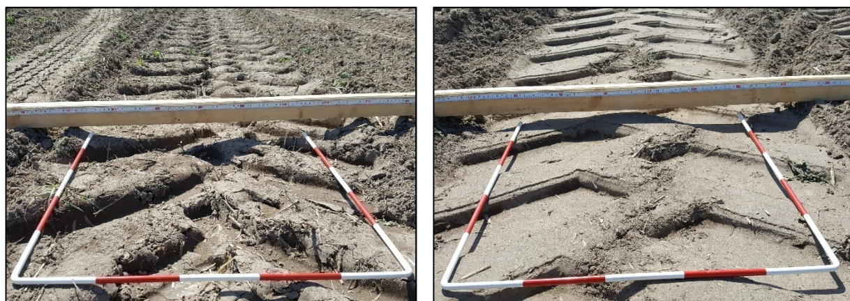
Obr. 2. Stopy pojezdových jednotek v povrchu půdy po přejezdech (vlevo: kolový traktor, vpravo: inovativní pásový tahač, 15. 8. 2017)
