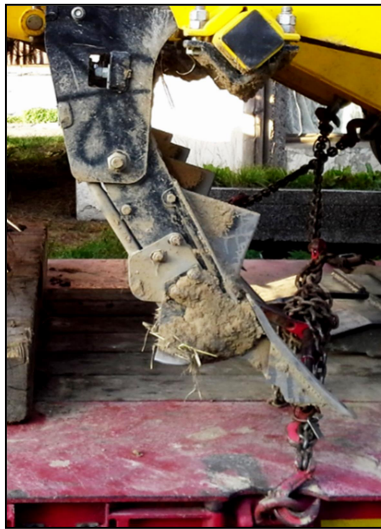
Obr. 2. vlevo: Detail radlice dlátového kypřiče s polo-parabolickým tvarem slupic, osazené v zadní části distribučním vedením a koncovkou pro souběžné řádkové podpovrchového uložení hnojiva do zóny půdního profilu. vpravo: Hlubkový dlátový kypřič osazený prototypním aplikačním rozvodem a řádkovými aplikačními koncovkami hnojiv a následná úprava povrchu půdy hrotovými válci.
