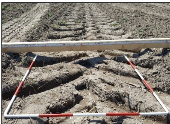
Obr. 4. Stopy pojezdových jednotek v povrchu půdy po přejezdech (vlevo: kolový traktor, vpravo: inovativní pásový tahač, 15. 11. 2017)
