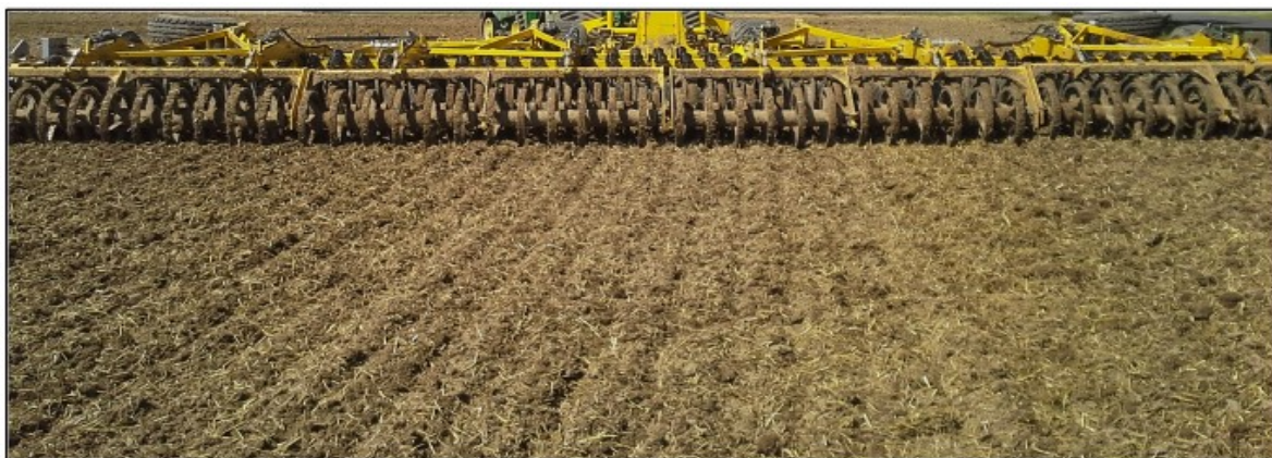
Obr. 3. Povrch zpracované půdy vyvíjenou technologií agresivní podmínky a zapravení posklizňových zbytků ječmene inovovaným talířových kypřičem (25. 8. 2017)
