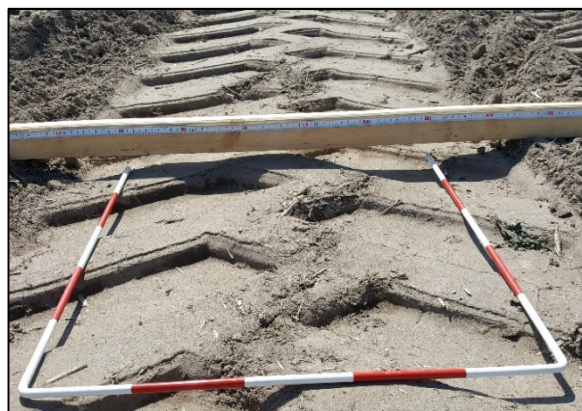
Obr. 4. Stopy pojezdových jednotek v povrchu půdy po přejezdech (vlevo: kolový traktor, vpravo: inovativní pásový tahač, 15. 11. 2017)
