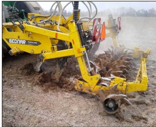
Obr. 2. vlevo: Detail radlice dlátového kypřiče s polo-parabolickým tvarem slupic, osazené v zadní části distribučním vedením a koncovkou pro souběžné řádkové podpovrchového uložení hnojiva do zóny půdního profilu. vpravo: Hlubkový dlátový kypřič osazený prototypním aplikačním rozvodem a řádkovými aplikačními koncovkami hnojiv a následná úprava povrchu půdy hrotovými válci.
