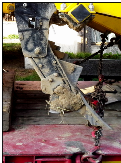
Obr. 2. vlevo : Detail radlice dlátového pluhu (kypřiče) s polo-parabolickými slupicemi (3x lomený pracovní úhel), osazený v zadní části trubicemi se šterbinovou koncovkou pro souběžné podpovrchové uložení hnojiva do zóny půdního profilu. vpravo : Profilové stimulační hnojení dlátovým pluhem (kypřičem) osazený prototypním aplikačním rozvodem a řádkovými aplikačními koncovkami hnojiv (do rýh).
