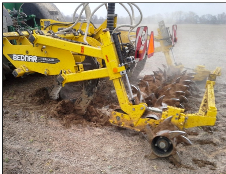
Obr. 2. vlevo : Detail radlice dlátového pluhu (kypřiče) s polo-parabolickými slupicemi (3x lomený pracovní úhel), osazený v zadní části trubicemi se šterbinovou koncovkou pro souběžné podpovrchové uložení hnojiva do zóny půdního profilu. vpravo : Profilové stimulační hnojení dlátovým pluhem (kypřičem) osazený prototypním aplikačním rozvodem a řádkovými aplikačními koncovkami hnojiv (do rýh).
